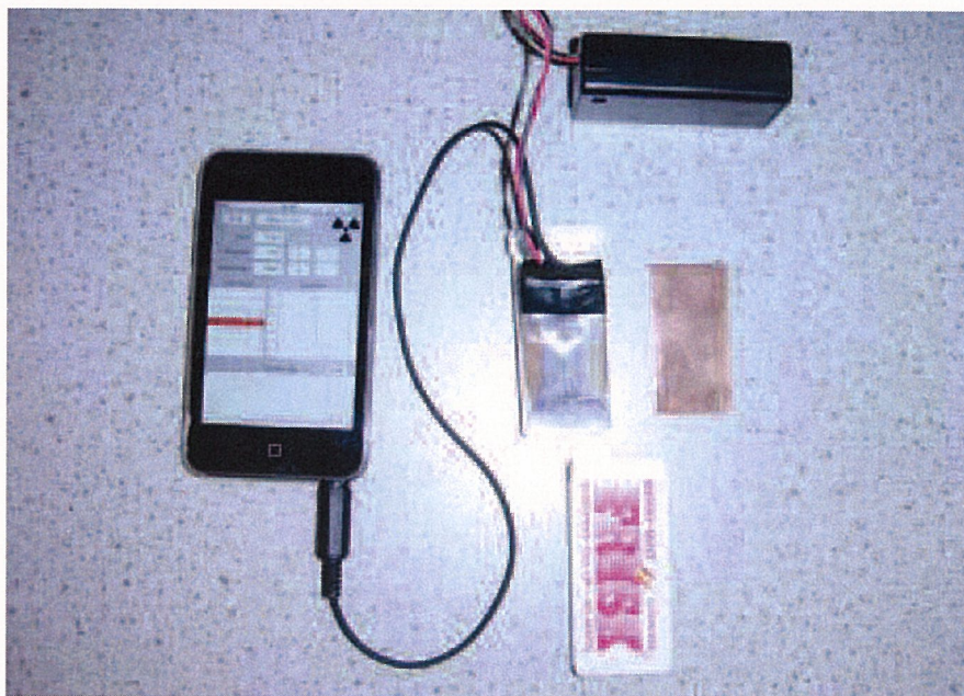
Figuur 1: Complete opengewerkte meetopstelling inclusief iPod. De print is omwikkeld met aluminiumfolie en bij de aansluitingen ook met zwarte tape. Daarnaast gelegen het Cu-plaatje van 1 mm dikte.
